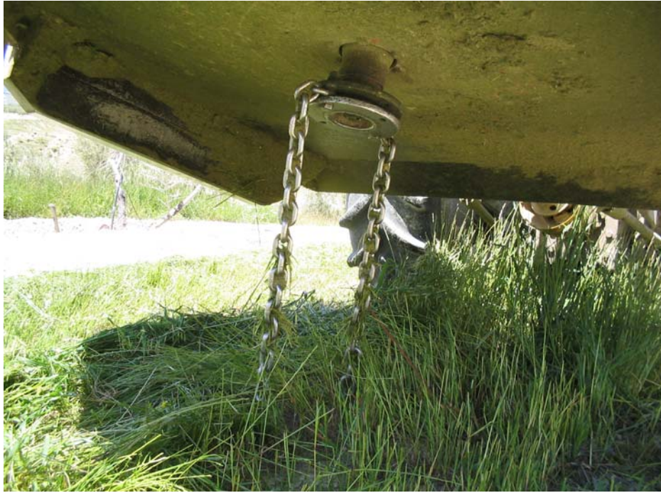
Figura 2. Desbrozadora de cadenas para control de la cubierta vegetal. Foto cedida por UNASUR
